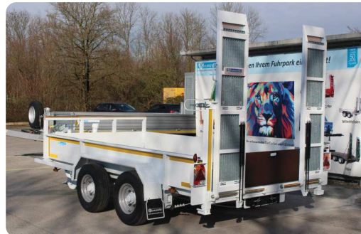
Gitterroste in den Rampen - mit zusätzlichen Gasdruckdämpfern
