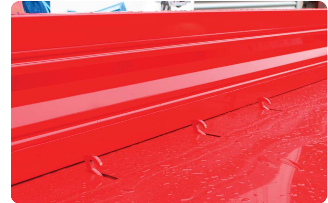
Zurrhaken mit 4000daN Zurrkraft im Kipperboden versenkt
