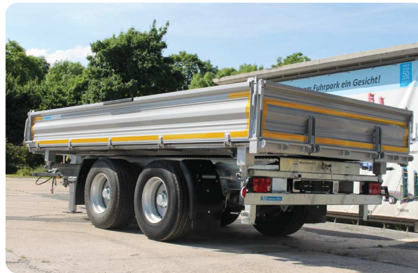
Typ 888/14000 mit Bereifung 385/55 R 19,5, Federhebern und verzinktem Chassis, Bordwände 50cm hoch – in Standardausstattung ca. 11t NL
