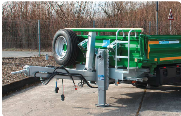
Auflagebock an der Stirnwand für Baggerschaufel, mit 3-stufiger Leiter und verzinktem Chassis
