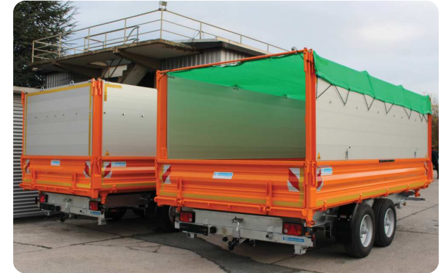
Häckselaufsatz ca. 1,20m hoch aus eloxierten Aluminiumbordwänden mit Gewebeplane und zusätzlicher PKW-Kupplung hinten angebaut
