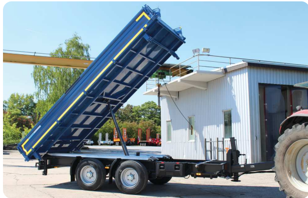
Typ 888/14000 mit Bereifung 285/70 R 19,5 verlängert auf 5,50m Ladeflächenlänge – in Standardausstattung ca. 11t NL
