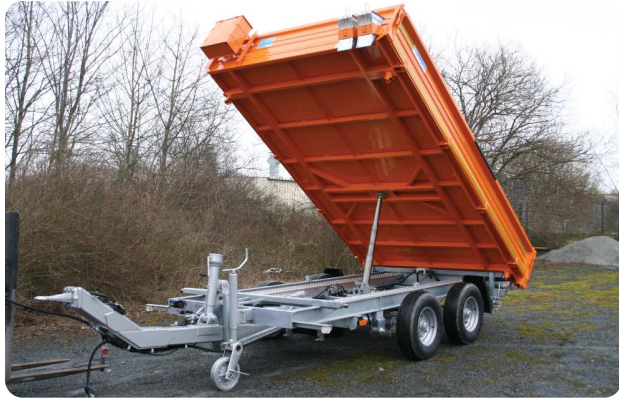
Typ 845/5000 mit Werkzeugkiste und verzinktem Chassis – in Standardausstattung ca. 3,1t NL
