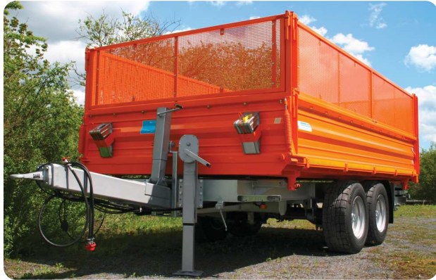
Lochblechaufsätze pendelnd und abnehmbar, große Bereifung 355/60R19,5, Federheber, Netzhaken, Chassis verzinkt
