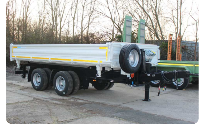
Typ 887/14000 (Typ 889/18000 ähnlich) mit 50cm hohen Bordwänden, Federhebern, Ablage für Baggerschaufel und Ersatzrad – in Standardausstattung ca. 10,75 bzw. 14t NL
