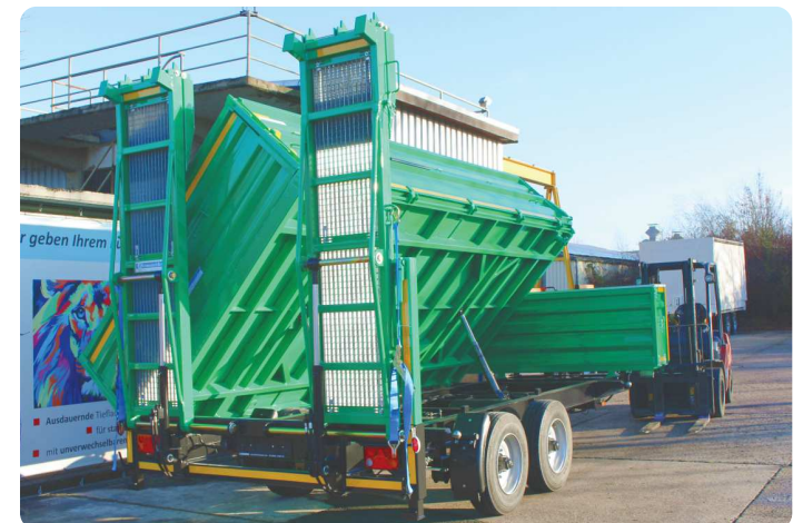
Mit Stahl-Zusatzbordwänden, doppeltem Staukasten, geteilten Rampen, Gitterrosten in den Rampen und hydraulischen Rampenhebern
