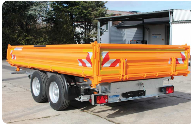
Typ 863/8900 ( Typ 852/6900 ähnlich) mit Warnmarkierung, Federhebern, verzinktem Chassis – in Standardausstattung ca. 6,45t NL
