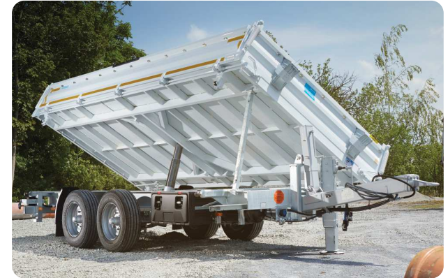
Typ 885/10500 (Typ 884/11900 ähnlich) mit Netzhaken, Federhebern, Werkzeugkiste, verzinktem Chassis, Zentralverriegelung – in Standardausstattung ca. 7,8 bzw. 9,2t NL
