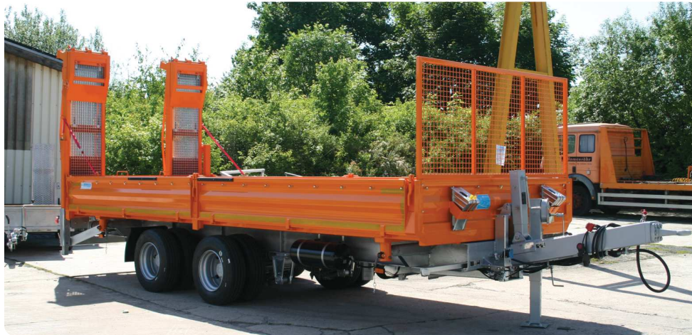
Stirnwanderhöhung aus Welldraht, Rampen verlängert und geteilt, verzinktes Chassis, Seitenbordwände geteilt, Gitterroste in den Rampen, Netzhaken
