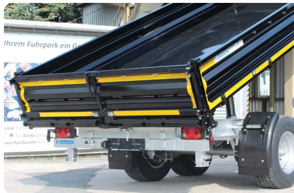
Flügeltür statt Pendelklappe, Netzhaken, große Bereifung, verzinktes Chassis und Netzhaken
