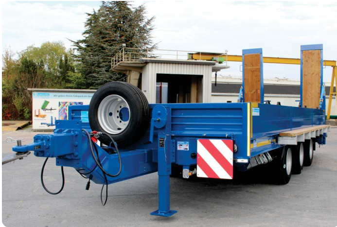
Tridem 25t GG mit Steckbordwänden aus Aluminium, Verbreiterung auf 3,0m, Warnpaket (beleuchtete ausziehbare Warntafeln, Halterung für Rundumkennleuchte) und Ersatzrad
