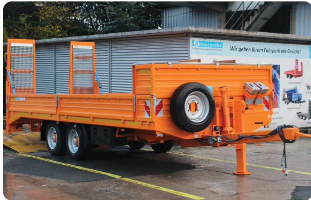
Doppelter Staukasten – mit Klappe unten und Deckel zum Beladen von oben, Hartholz für Ablage Baggerschaufel, verbreiterte Rampen, geteilte Bordwände, Ersatzrad, Netzhaken
