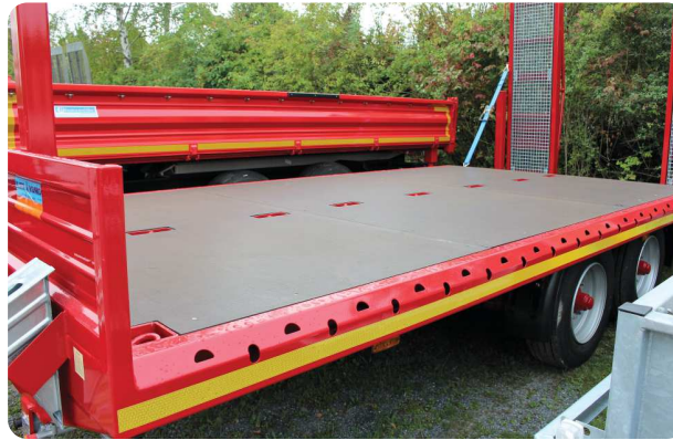
Außenprofil Ovalloch/Halbmond (2000daN Zurrkraft) mit mittlerer Zurrleiste aus Zurrkästen (4000daN)
