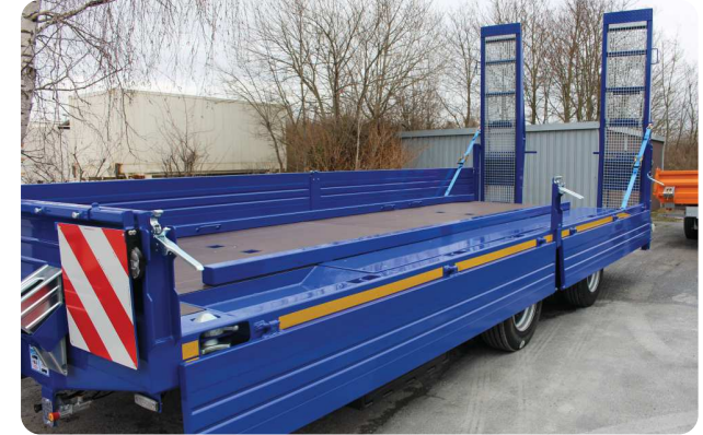
Kombinationstieflader: geeignet für den Transport von Abrollcontainern und von Baumaschinen als auch Containern - mit steckbarer Führung für die Abrollcontainer
